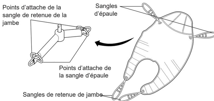
**Barre d'écartement à 6-points;** Exemple d'une courroie pour barre d'écartement à six points munie d'attaches en boucle.
