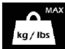
Si le lève-personne s'arrête en raison d'une surcharge (la charge à lever est supérieure à la charge maximale autorisée), le symbole de surcharge s'affiche sur l'écran LCD et le fonctionnement du lève-personne est interrompu. Abaissez le bras et éliminez le poids en excès.
