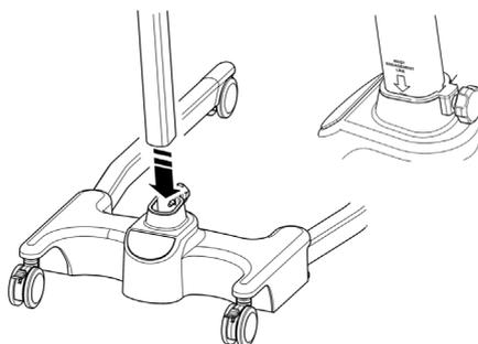
3. Apriete el conjunto de mástil con el dispositivo de bloqueo del mástil, que está situado en la parte delantera del chasis.
