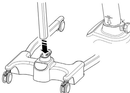
3. Resserrez le mât à l'aide du dispositif de verrouillage du mât situé devant le châssis.
