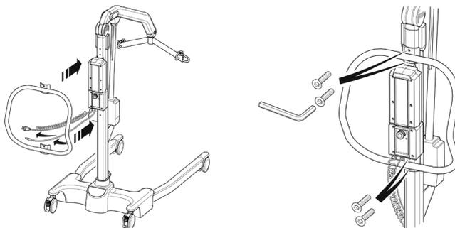
6. Remplacez le bloc d'alimentation sur le lève-personne et vérifiez que la bride le maintenant est totalement enclenchée. Enclenchez le bloc.
