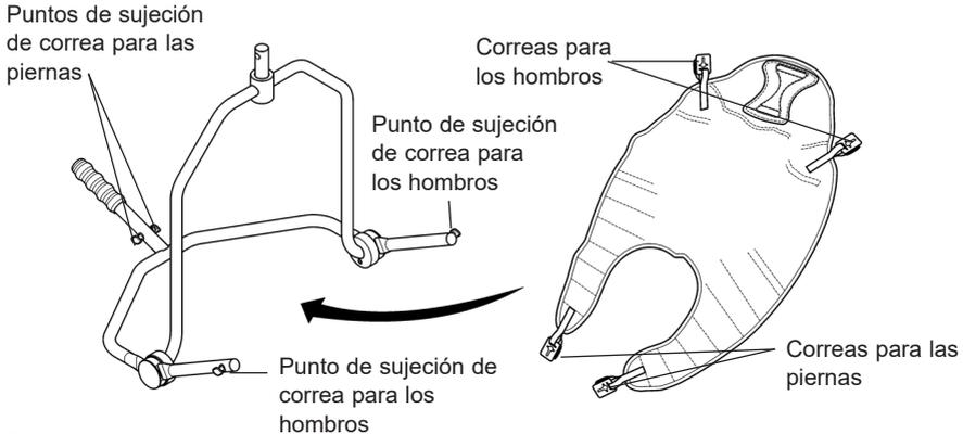
**Percha de 4 puntos;** ejemplo de la eslinga de la percha de 4 puntos con sistema de clip de seguridad.
