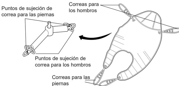
**Barra de extensión de 6 puntos;** ejemplo de la barra de extensión de 6 puntos con sujeciones de bucle.
